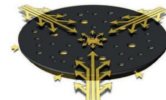
Каналы поступления воздуха, идущие к центру подошвы, усиливают воздушную тягу, обеспечивая тем самым эффективное пылеудаление через центральное отверстие.
